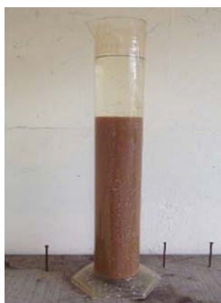
รูปที่ 5. การแยกตัวของน้ำและตะกอนจากการเก็บตัวอย่างน้ำระบายตะกอน 1,000 มิลลิลิตร
